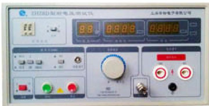
本系列耐电压测试仪适用于各种电机、电器、仪器仪表和家用电器，以及强电系统的安全耐压和漏电流的测试。该仪器操作方便，安全可靠，性能良好，维修方便。是符合 GB4706.1 《家用和类似用途电器安全通用要求》和 GB9706.1 《医用电气安全通用要求》及 GB4943、GB4793 等国家标准中相关条款的试验要求所需的测试设备。
